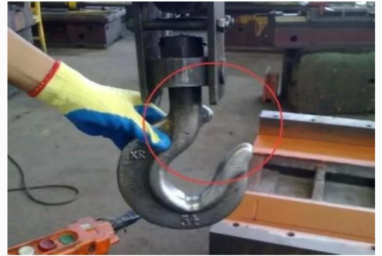
吊钩无防脱钩装置
