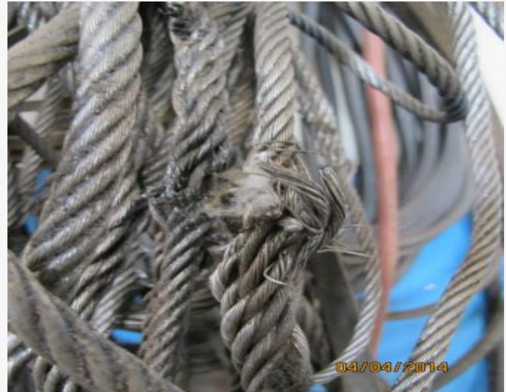
隐患：钢丝绳维护和更换不合规出现疲劳损伤
