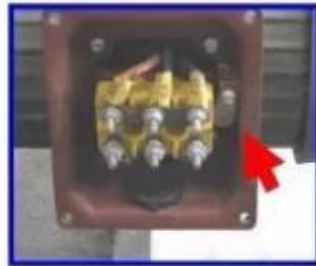
电机的保护 接地端子
